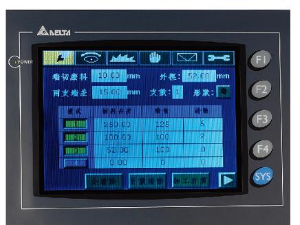
触控人机介面，方便操作者进行各项工作设定及机器使用。NC伺服控制，确保切削成品之准确性与可靠度。
