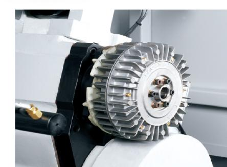
特殊设计之锯片主轴组，可吸收锯片震动及防止锯片弯曲，并增加其刚性。再加上独特背隙机构机构，可保持切削力量稳定，大幅延长锯片寿命以提升加工品质。
