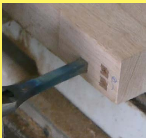
圖八：方孔鑽模組 Fig.8: Square drill module
