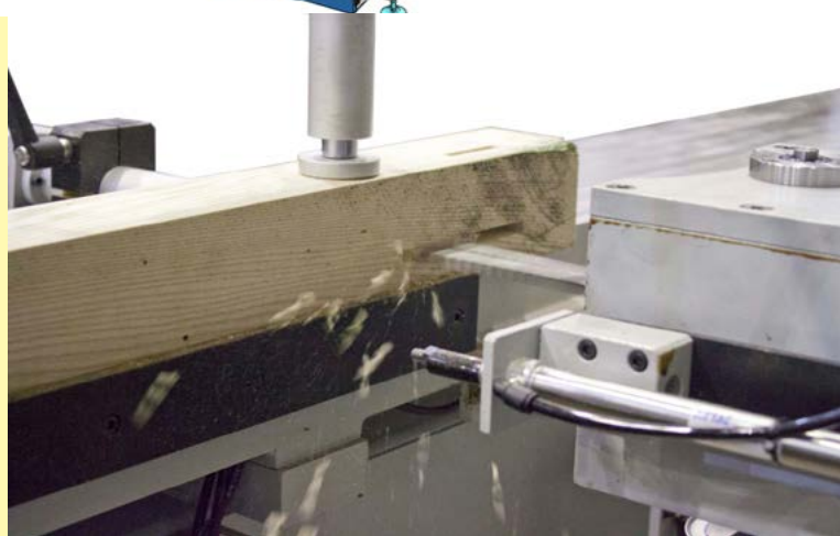
> 圖七：鑿刀模組 Fig. 7: Chisel module
