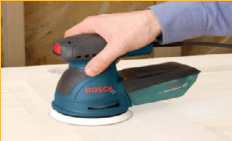
使用砂光機磨平表面 Smoothen surface with sanders
