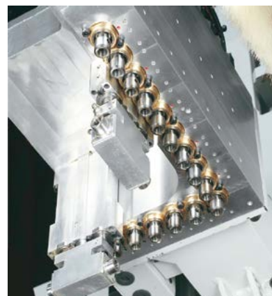
排鑽組配備有 16 個垂直鑽和 2 個雙向水平鑽
