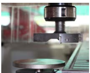
刀長量測裝置 直徑為 100mm.
