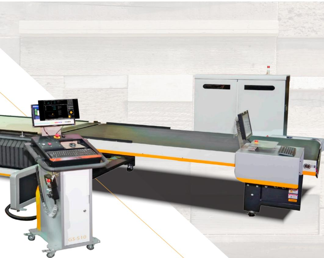
搭配線馬的 GS 機台，Y 軸龍門移動速度可以達到 120 米，直線木板切割速度可以達到 60 米，整個高速移動過程非常靈敏有力。由於機台移動速度變快加上軟體快鑽功能的配合，機台整體的加工時間也變快許多，讓客戶在相同的工作時間下可以創造出更多的產能。
