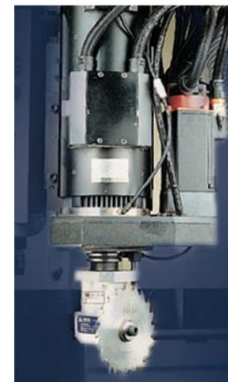
恩德開發了高標準的重型主軸技術，主軸適合所有常用的工具系統。此外，恩德主軸上裝有標準冷卻系統和可與可選的水冷卻系統。該主軸可用於 STRATOS 系列採用了 360°C 軸與標準的自動換刀的功能
