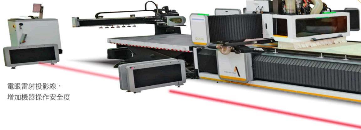
電眼雷射投影線，增加機器操作安全度
