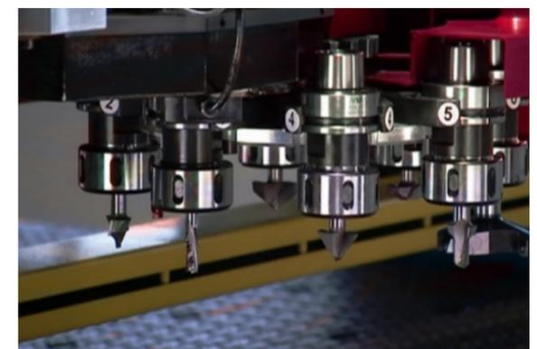
**刀盤式換刀機構**
