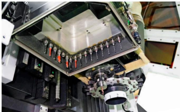
10 把伺服系統刀盤式換刀機構
