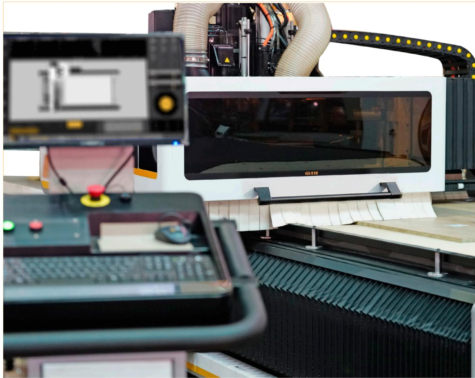
近年來隨著客戶加工精度、速度以及效率的要求越來越高的情況下，使用旋轉伺服馬達搭配螺桿進行平面移動加工的木工機械不易滿足客戶產能。有鑑於此，恩德投入更高階傳動元件 - 線性馬達的研發行列，為了提供最佳性價比的線性馬達給各種木工機械使用，以滿足客戶更高階應用的需求。
